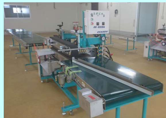
ねぎの洗浄設備
